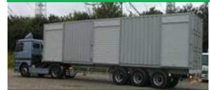
代替熱交換器車配備 (通常時高台待機)
