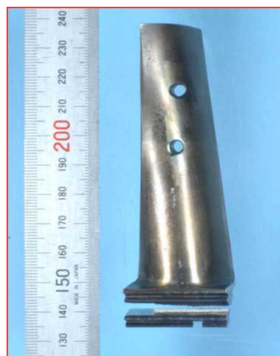
L側タービンブレード 外観（背面側）
