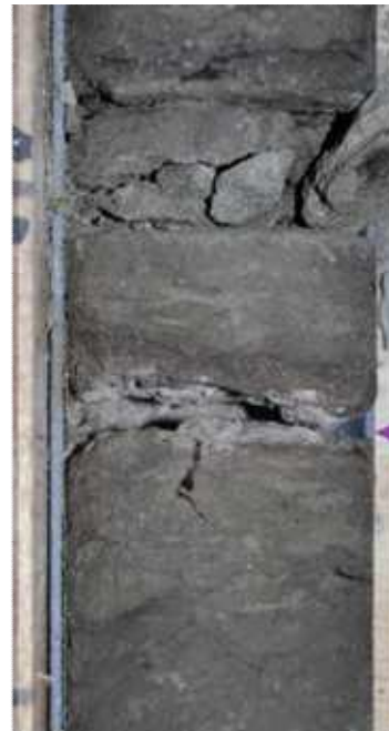
敷地で確認された火山灰 (加久藤テフラ: 標高-30.2m)
