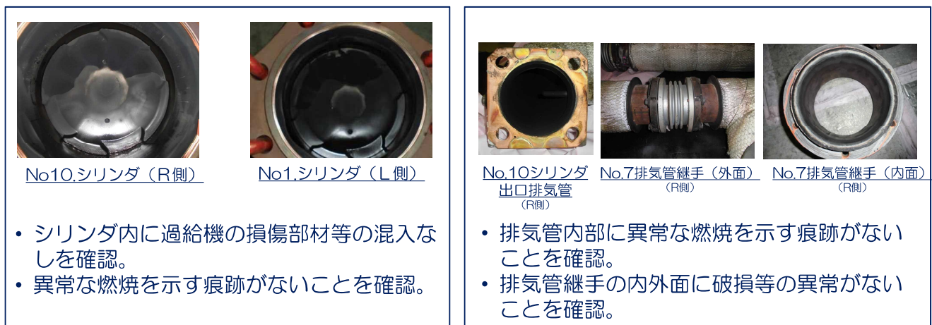
シリンダ内部点検結果
