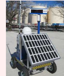
線量率モニタの設置状況
