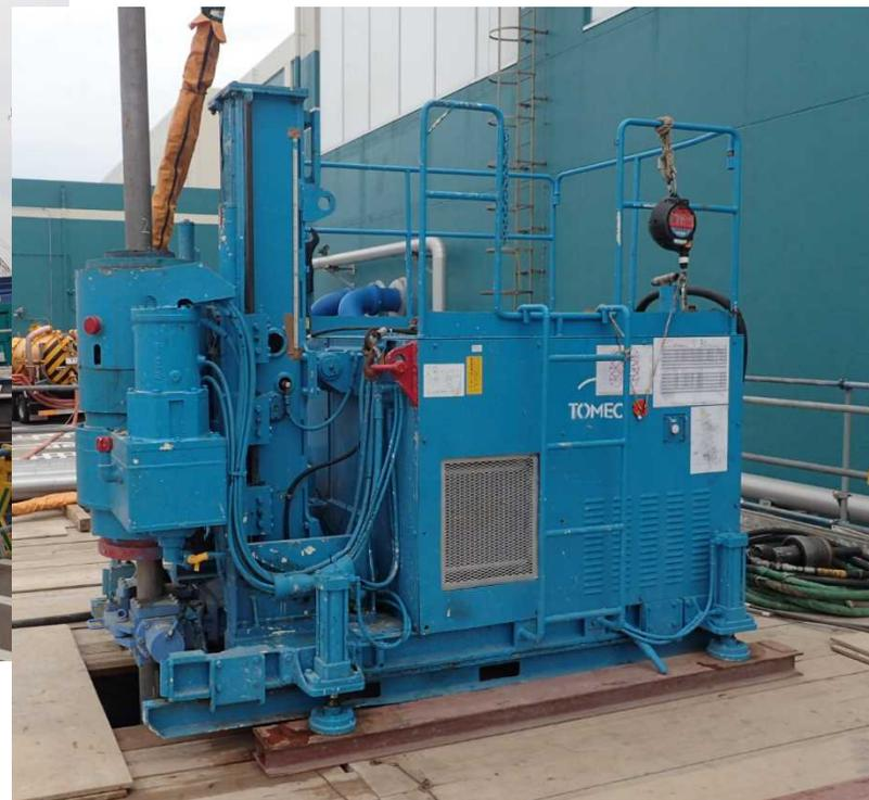
地中に高圧の空気、水、セメントミルクを噴射し、地中の砂を切削し、セメントミルクと混合・置換し、改良体を造成します
