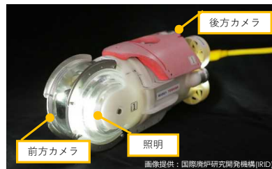
3号機 原子炉格納容器内部確認用 水中遊泳式遠隔調査装置 (ROV)
