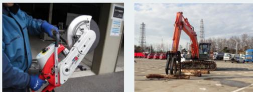
優良提案を実現した「津波等で発生したガレキを除去するための資機材配備【左】エンジンカッター（福島第二）【右】つかみ機を取付けたバックホウ（柏崎刈羽）」
