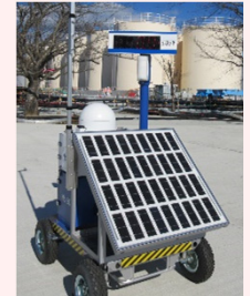
線量率モニタの設置状況
