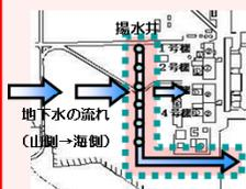
山側から流れてきた地下水を建屋の上流で揚水し、建屋内への地下水流入量を抑制する取組(地下水バイパス)を実施。くみ上げた地下水は一時的にタンクに貯留し、東京電力及び第三者機関により、運用目標未達であることを都度確認し、排水。揚水井、タンクの水質について、定期的にモニタリングを行い、適切に運用。建屋と同じ高さには設置した観測孔において地下水位の低下傾向を確認。建屋への地下水流入をこれまでのデータから評価し、減少傾向を確認。
