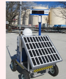
線量率モニタの設置状況
