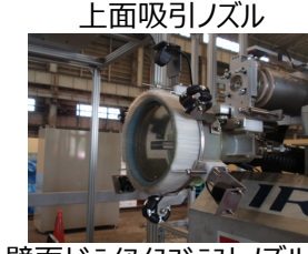
図6：高所用ドライアイスブラスト除染装置の概要
