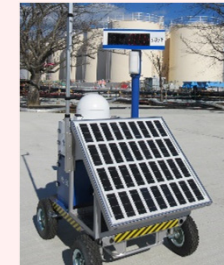
線量率モニタの設置状況
