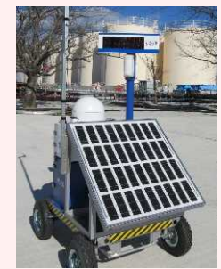
線量率モニタの設置状況
