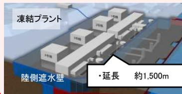
建屋への地下水流入を抑制するため、建屋を囲む陸側遮水壁の設置を計画。2014/6/2から凍結管の設置工事を実施し、2016/2に凍結設備の工事完了。2016/3より凍結を開始。
