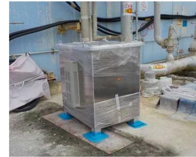
図4：ミュオン測定装置(小型装置)
