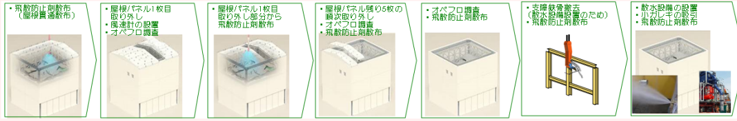
建屋カバー解体の流れ(至近の工程)
