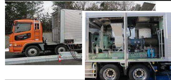
ガスタービン発電機車 (高台配備)
