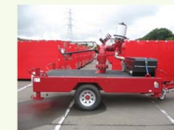
大容量放水設備を配備、重大事故に伴い放射性物質が放出された場合、湿分による沈着を図る
