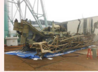
撤去した燃料交換機
