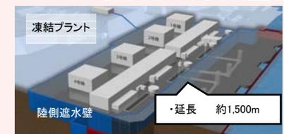
建屋への地下水流入を抑制するため、建屋を囲む陸側遮水壁の設置を計画。2014/6/2から凍結管の設置工事中。先行して凍結を開始する山側部分について、凍結管の設置が約72%完了。
