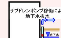
サブドレン水汲み上げによる地下水位低下に向け、1~4号機の一部のサブドレンピットについて浄化試験を実施。今後、サブドレン復旧方法を検討。
