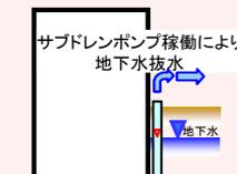
サブドレン水汲み上げによる地下水位低下に向け、1~4号機の一部のサブドレンピットについて浄化試験を実施。今後、サブドレン復旧方法を検討。
