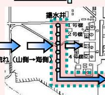
山側から流れてきた地下水を建屋の上流で揚水し、建屋内への地下水流入量を抑制する取組(地下水バイパス)を実施。
