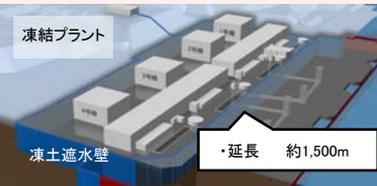
建屋への地下水流入を抑制するため、凍土壁で建屋を囲む陸側遮水壁の設置を計画。
