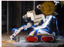
吸引・プラスト除染装置
