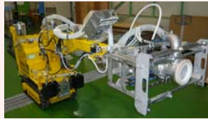
高圧水除染装置
