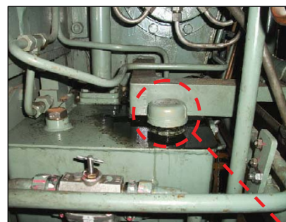
動弁注油タンクからの漏えい箇所
