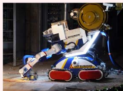
吸引・プラスト除染装置
