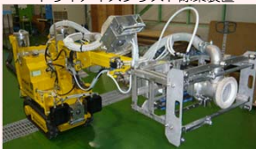
高圧水除染装置
