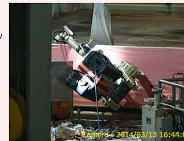
遠隔操作ロボット転倒状況
