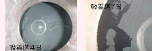
吸着材の表層部に灰色の堆積物(炭酸塩と推定)を確認。
