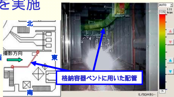
<格納容器ベントに用いた配管周辺のガンマカメラ撮影データ>
