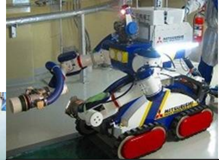
ブラスト・吸引回収除染装置
