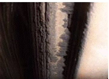
例：チューブ燃焼灰付着状況
