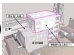
燃料取り出し用カバーの設置
