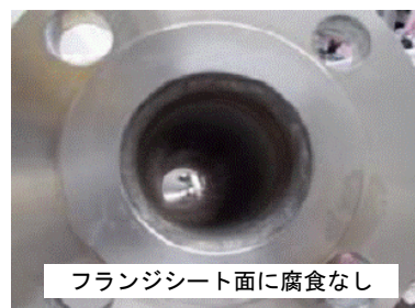
スラリー移送ポンプ出口配管フランジ
