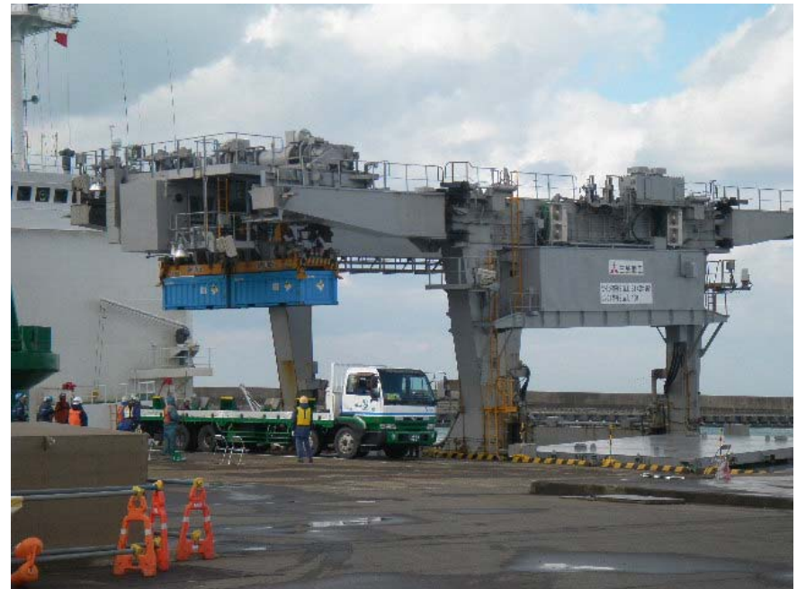
船載クレーンによる輸送容器の船積み
