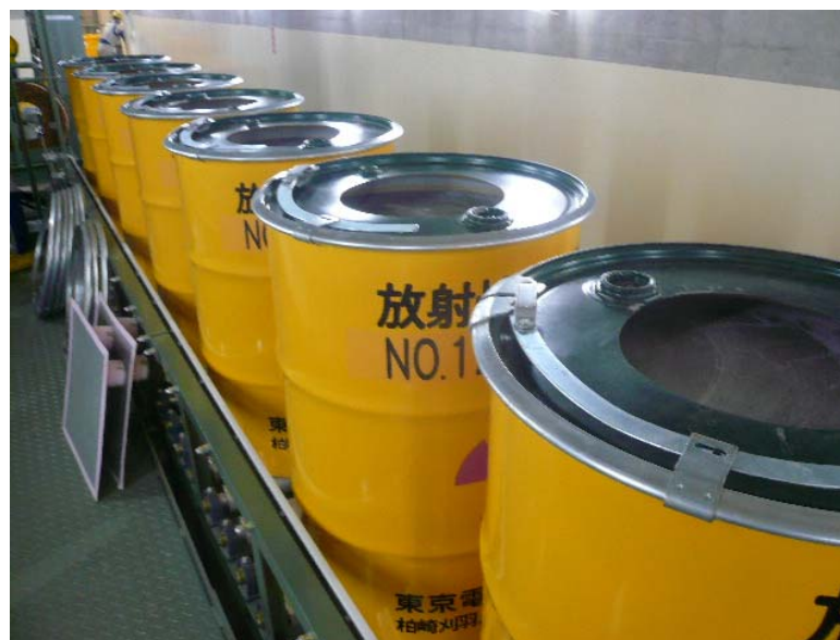
モルタル充填し、固型化
