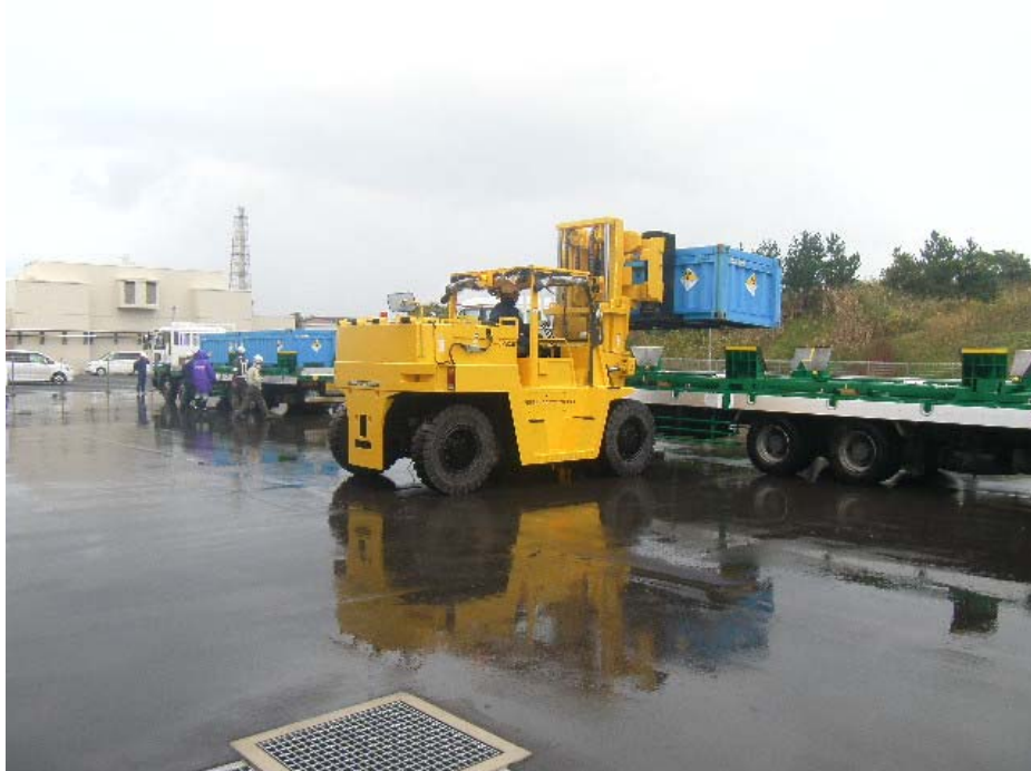
輸送容器のトレーラーへの積込み
