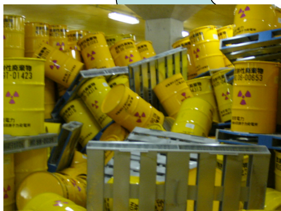
中越沖地震によりドラム缶転倒
