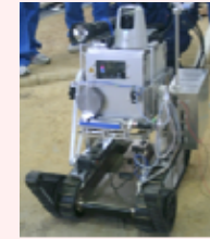
汚染状況調査用ロボット (ガンマカメラ搭載)
