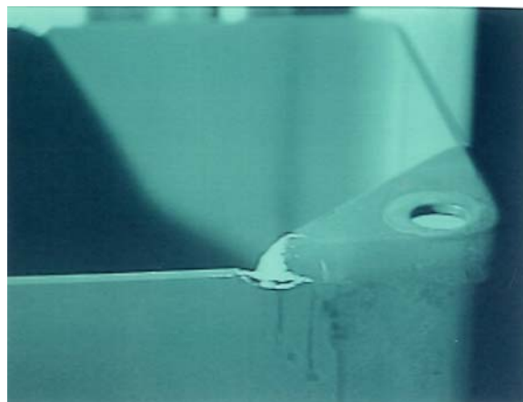
K5 剥離状況（V89H567）
