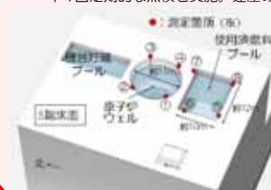
傾きの確認(水位測定)
