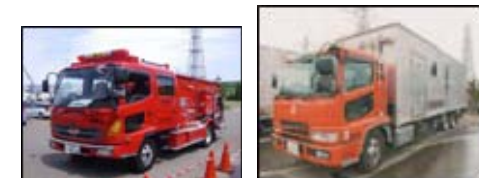
例. 消防車, 空冷式ガスタービン発電機車
