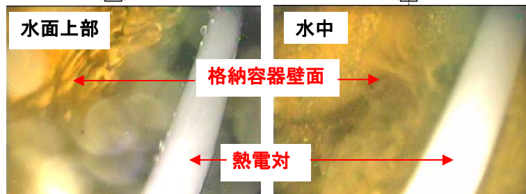
図1：2号機原子炉格納容器内部調査結果
