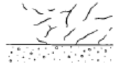
不規則なひび割れ※2
