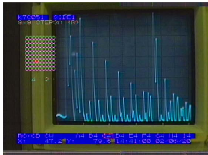
浸水燃料棒の測定波形例 (健全燃料棒に比べ信号が弱い)
