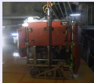
＜HTI 1階の集積作業用ROV＞ (3月5日撮影)
