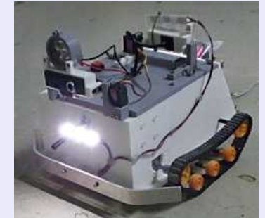
<クローラーロボット（直営で製作）>
