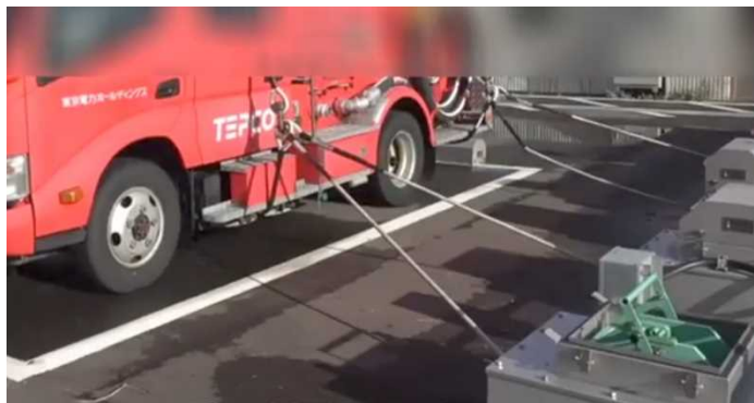
竜巻対策固縛装置（巻き取り装置）
