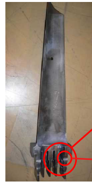
第14~16段 動翼の構造 (付根部:フォーク型)
