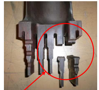
第14段動翼の損傷状況 (折損)
