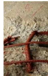
No.8杭主筋の破断状況
