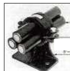
ケーブル縮みを抑え、シースずれを生じさせないように、直線接続部両端の近傍を「ブラケット」により固定
