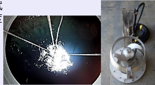
<攪拌時のタンク 水面の状況> <攪拌装置>
