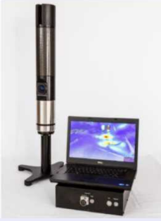
<測定装置(γイメージャ※)> ※γ線測定結果と3Dスキャン情報を組み合わせ、γ線の3次元分布を取得
