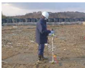
仮置場除去土壌等搬出完了後の空間線量率測定
