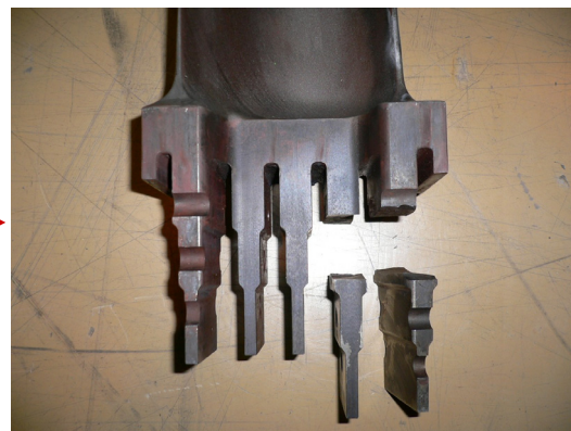
フォーク損傷部(119枚目)
