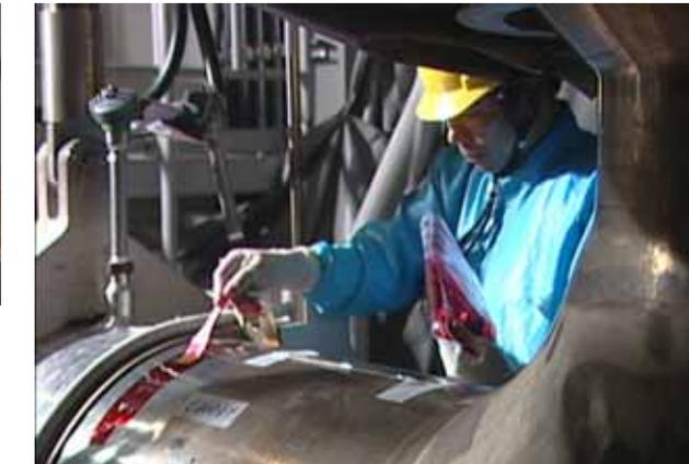
液体浸透探傷検査
