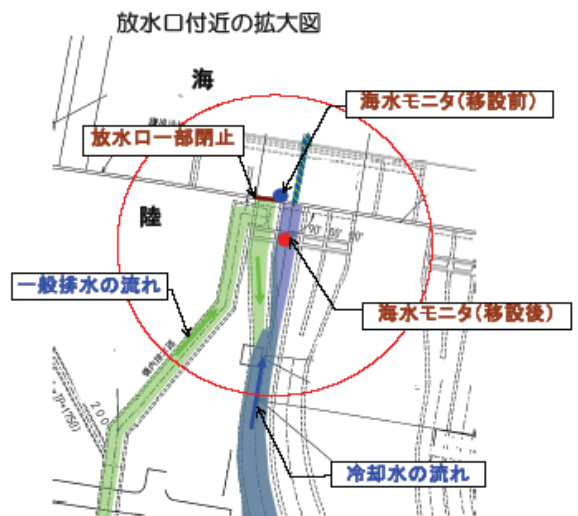
青色が1号機放水路（冷却水） 緑色が構内排水路（主に降雨時の雨水）
