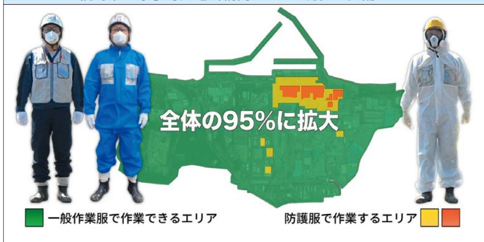
福島第一原子力発電所構内における現在の装備エリア
