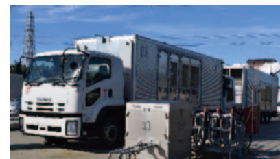
ガスタービン発電機車
