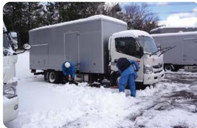
降雪時に電源車の周りを除雪し起動する訓練
