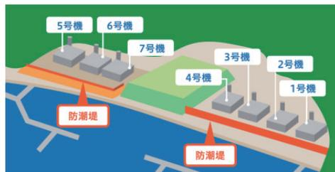
津波による敷地内の浸水を防ぐため、海拔約15mの防潮堤を設置しました。敷地内が浸水した場合に備えて、海側への排水設備も設置しました。
