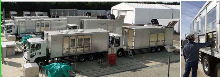
非常時の電源を供給するガスタービン発電機車
