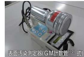
表面汚染測定器(GM計数管<sup>(※2)</sup>式)
